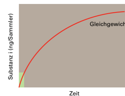
Abb. 2: Substanzzunahme im Passivsammler bei konstanter Wasserkonzentration. Die Konzentration einer Substanz im Sammler steigt, bis die Aufnahme- und Abgabeprozesse ins Gleichgewicht kommen. Für Zeit integrierte passive Probenahme sollte die Expositionszeit der Sammler nicht zu lang sein (grüner Bereich).
