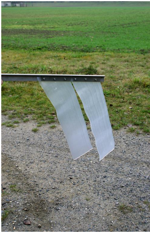
Abb. 14 > Zwei montierte PDMS-Passivsammler kurz vor dem Einsetzen im Gewässer
