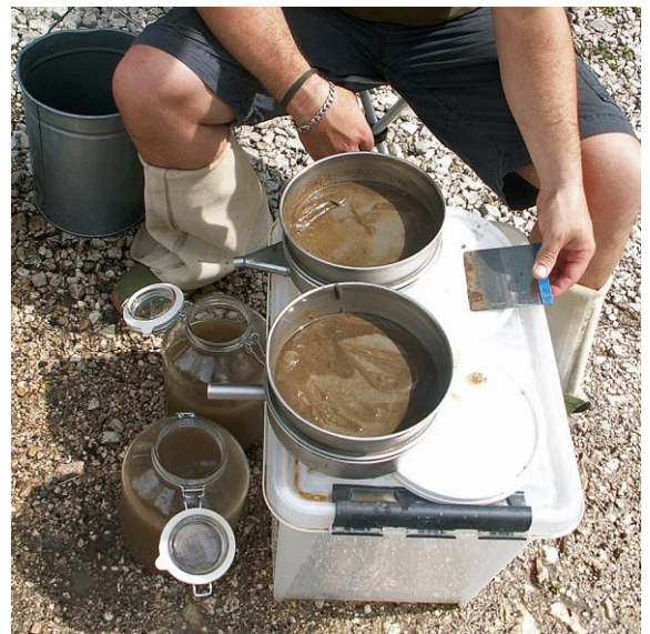
Abb. 32 > Größere Sedimentrückstände im <0,063\text{-mm} -Sieb nach beendiger Filtration der Feinpartikel
