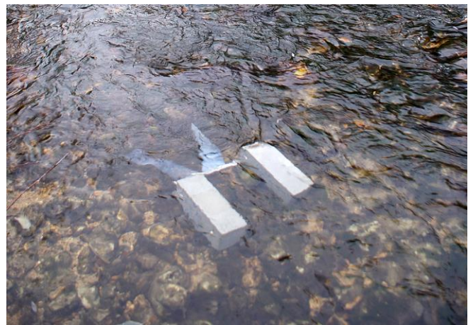
Abb. 19 > Zum Schutz des Passivsammlers vor Algen und Treibgut kann in einem Abstand von ca. 30–50 cm vor dem Sammler eine Stange platziert werden
