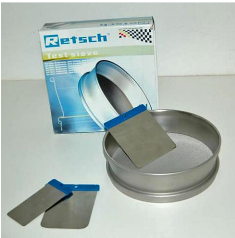
Abb. 29 > Metallsieb (63 \mu\text{m} ) mit an den Kanten abgerundeten Metallspachteln
