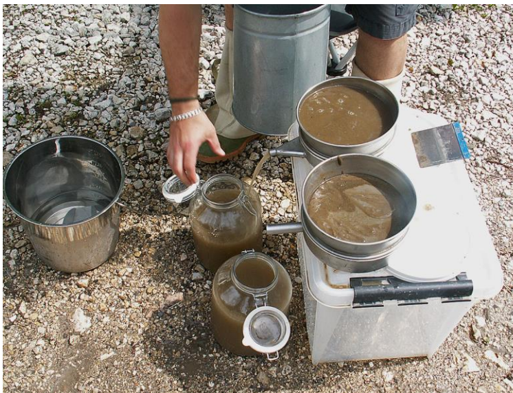
Abb. 31 > Filtration einer Sedimentprobe durch das <0,063\text{-mm} -Sieb direkt in ein 5-l-Glasgefäß
