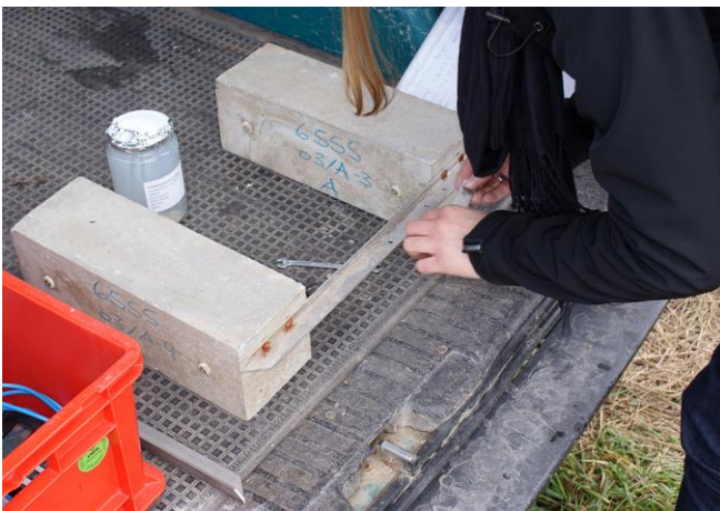
Abb. 18 > Befestigung eines PDMS-Passivsammlers an einer Metallstange und zwei Metallfüssen (ehemalige Bremsklötze von Eisenbahnwagen) mit reissfesten Schnüren
