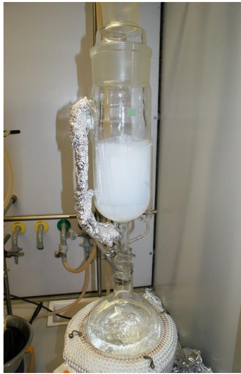
Abb. 15 > Grosse Soxhletapparatur mit 2-Liter-Rundkolben zur Vorextraktion von maximal sechs PDMS-Passivsammlern mit Ethylacetat und Methanol
