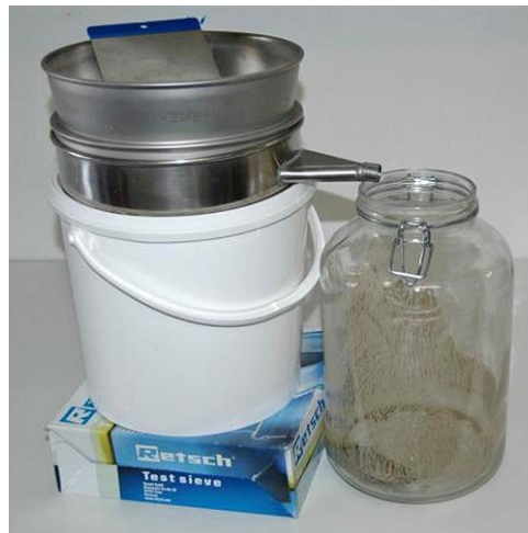
Abb. 30 > Metallsieb (63 \mu\text{m} ) auf Trichteraufsatz mit Ausguss und 5-Liter-Auffanggefäß
