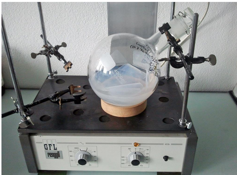
Abb. 20 > Beladen von PDMS-Passivsammlern mit PRC auf einer Schüttelmaschine
