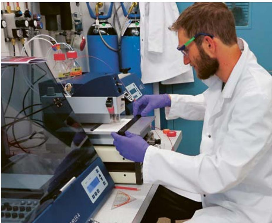
Alan Bergmann positioniert eine Dünnschichtplatte, um eine mit Biotests sichtbar gemachte Bande auszuschneiden und auf ihre chemische Struktur zu untersuchen.
