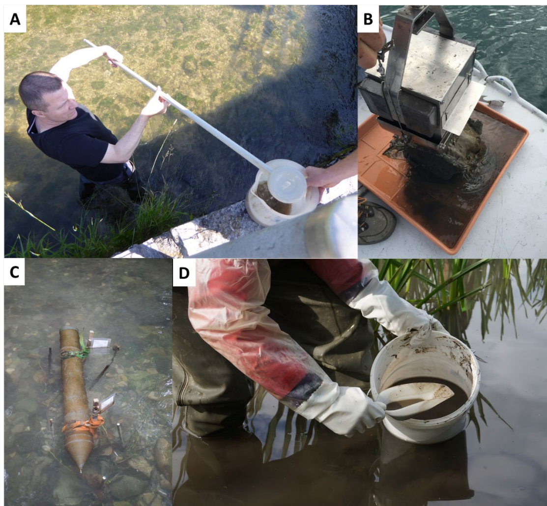
Abbildung 5: Verschiedene Probenahmeegeräte, die im Feld verwendet werden können. A) Teleskop-Probennehmer B) Ekman-Greifer C) Zeitintegrierter Schwebstoff-Röhrensammler D) Schaufel.
