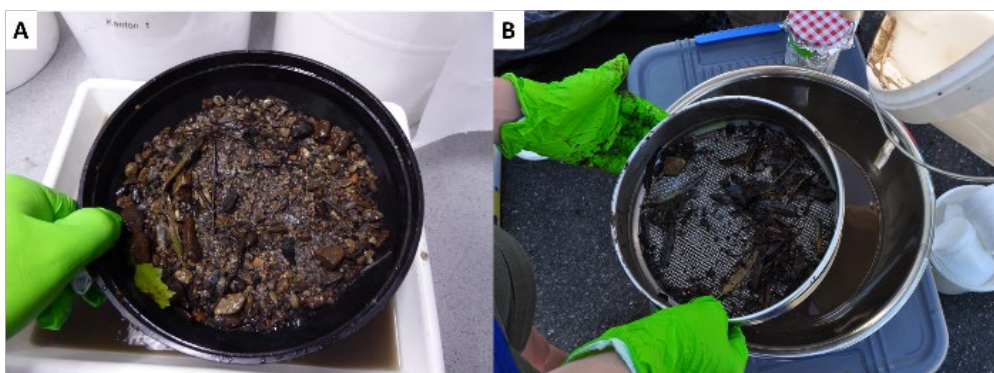
Figure 7 : Exemples de tamisage humide à 2 mm. (A) Hors site avec des matériaux inertes pour l'analyse des métaux et (B) in situ avec des matériaux inertes pour l'analyse des micropolluants organiques.
