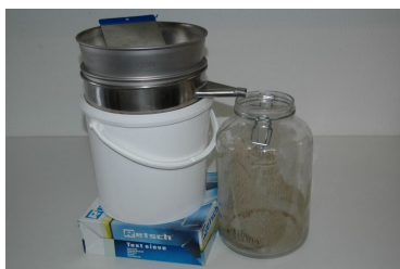
Figure 8 : Système de tamisage pour isoler la fraction < 63 µm (Photo : canton de Berne).
