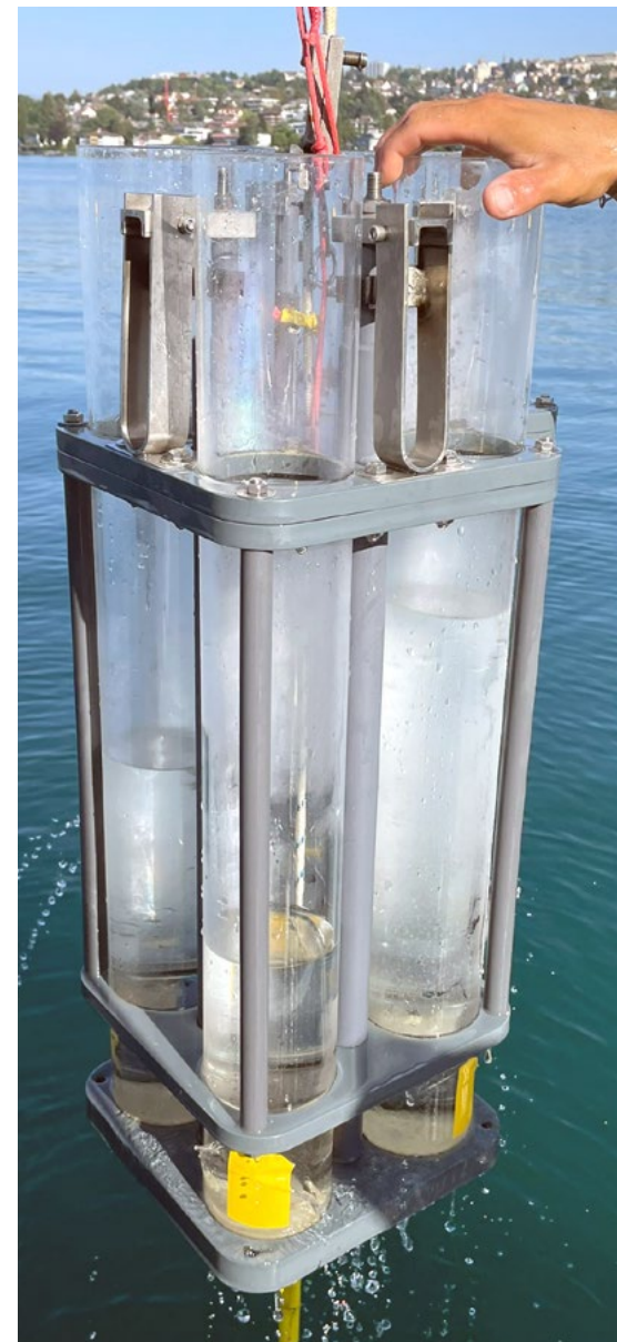
Mit Hilfe von Schwebstofffallen wurden Schwebstoffe im Genfersee gesammelt.
